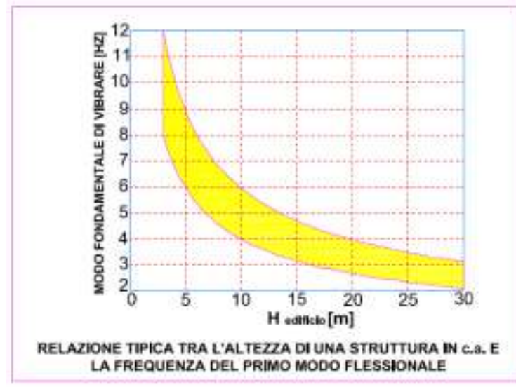
Figura 3: Relazione tra altezza di una struttura in cemento armato e la frequenza del primo modo flessionale.
